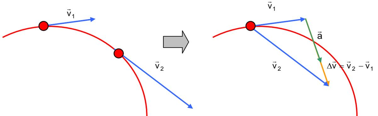
Si descomponemos dicho vector en dos componentes: una tangente a la trayectoria (aceleración tangencial) y otra perpendicular (aceleración normal) según el esquema, observamos que todo movimiento circular consta de estos dos tipos de aceleración.
