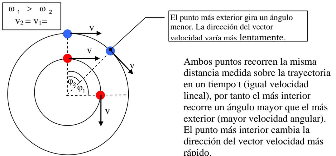
Ambos puntos recorren la misma distancia medida sobre la trayectoria en un tiempo t (igual velocidad lineal), por tanto el más interior recorre un ángulo mayor que el más exterior (mayor velocidad angular). El punto más interior cambia la dirección del vector velocidad más rápido.
